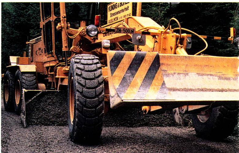
**Fein Planieren:** Mit dem Grader kann eine sehr saubere und ausgeglichene Bombierung erreicht werden.
